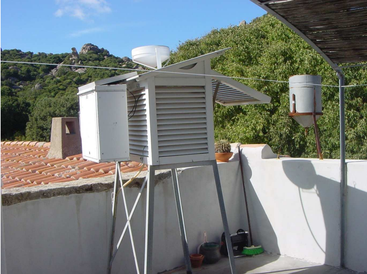
Figura A4b: capannina meteorologica attualmente in funzione nel sito di Aggius.
