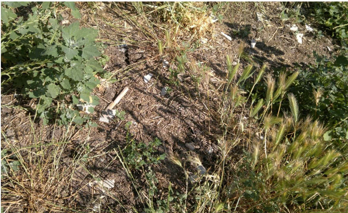
Figura 7 - Resti di frammenti delle lastre di copertura contenenti fibre di amianto presenti intorno all'area del fabbricato.
